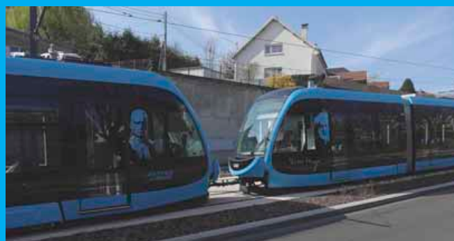
AVANT LA MISE EN SERVICE DU TRAM, DIFFÉRENTES SITUATIONS TECHNIQUES SONT TESTÉES : ICI, L'ATTELAGE D'UNE RAME À UNE AUTRE NÉCESSAIRE EN CAS DE REMORQUAGE D'UNE RAME EN PANNE.
